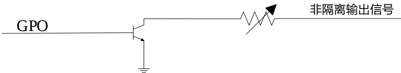
图5-10 非隔离输出内部电路
